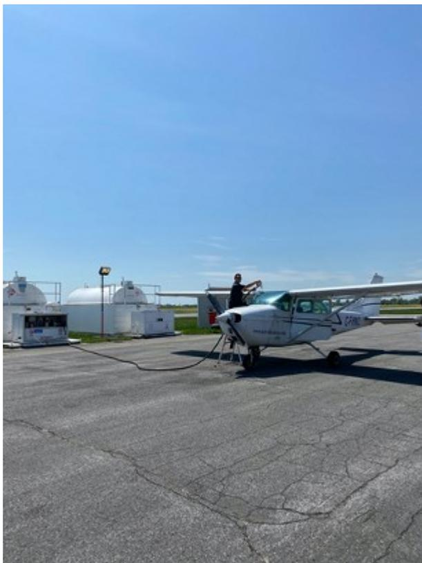
Une des raisons pour laquelle l'aviation de tourisme garde ses réservoirs pleins après chaque vol est que cela prévient l'infiltration d'eau dans les réservoirs dû à la condensation. Nos avions ne volent pas à tous les jours et cette pratique fait du sens si l'avion est stationné à l'extérieur. Un avion de ligne, lui, vole à tous les jours, évitant les arrêts prolongés où l'humidité peut s'accumuler dans les réservoirs.
