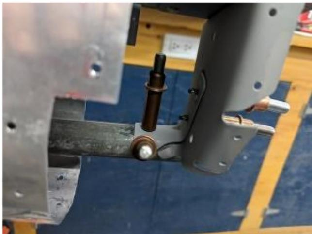
P4: Test sur l'aileron de la languette – notez le petit bout de la languette originalement faite avec la nervure
