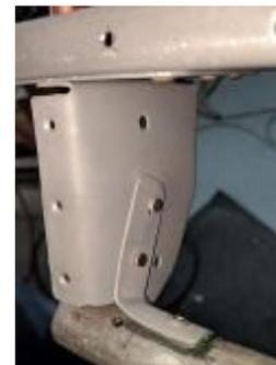
P6: Nervure installée et rivetée.
